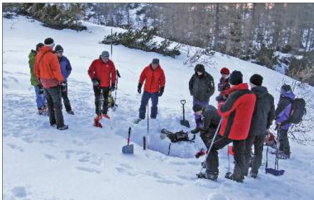
Slika 2: Preizkušanje snežne odeje za napoved nevarnosti proženja snežnih plazov na Zelenici 8. 3. 2012.
