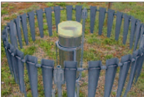
Slika 3: Dežemer z Alterjevim ščitnikom (NCAR 2010).
