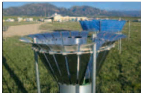
Slika 4: Dežemer s prirerjenim (NCAR) Nipherjevim ščitnikom (NCAR 2010).
