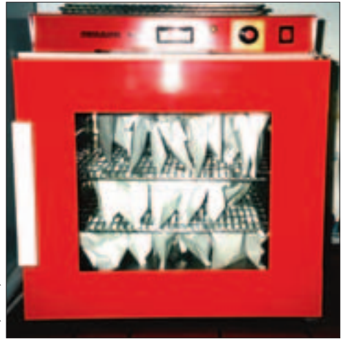
Slika 8: Sušenje vzorcev listja v sterilizatorju pri 70°C (Sterilizator S-45, UL BF).
