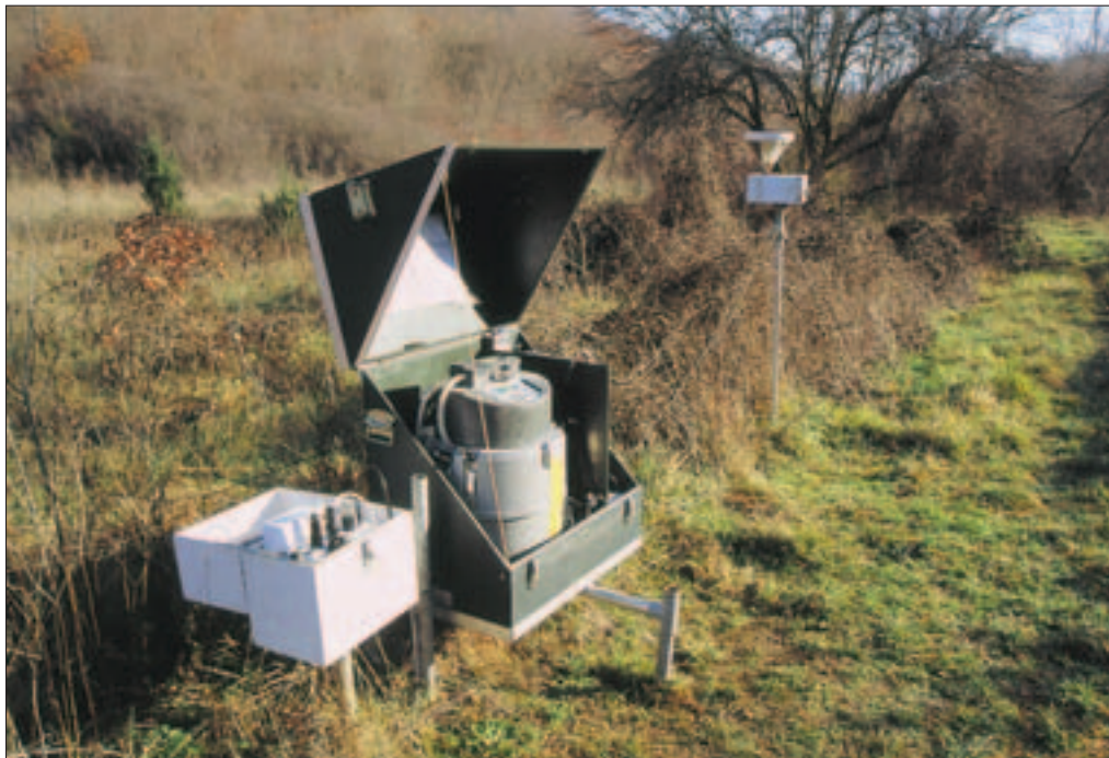
Slika 11: Avtomatski vzorčevalnik ISCO 3700 za merjenje suspendiranega gradiva v vodi; desno je postavljen dežemer.
