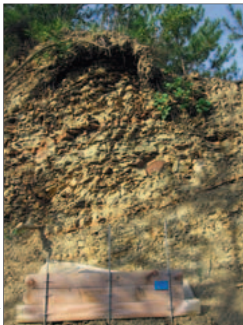
Slika 7: Polodprto erozijsko polje (zaprto zgoraj) za merjenje sproščanja kamnin (Zorn 2007a; 2007b).
