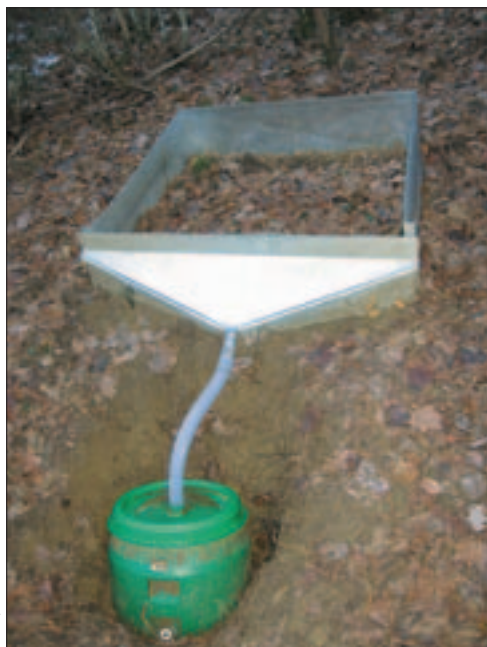
Slika 6: Zaprto erozijsko polje za merjenje erozije prsti (Zorn 2007a; 2007b).
